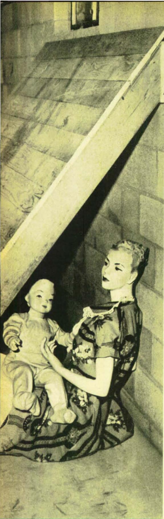
Unter dieser behelfsmäßigen Schutzvorrichtung haben Puppen die Atombombendetonation 'überlebt'. Die in Nevada angestellten Versuche bewiesen, daß bei geeigneten Vorkehrungen ein Überleben für den Menschen bei Atomangriffen möglich ist.
