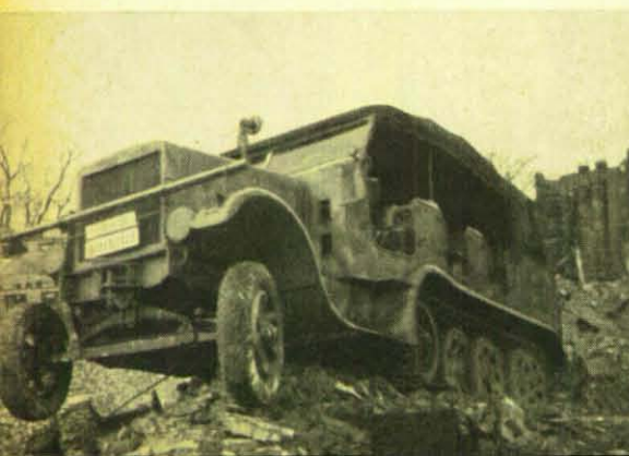
Halbgleiskettenfahrzeug (18-t-Zugmaschine), festgefahren an einem Schuttkegel. Durch ▼ Trümmernmassen unbeweglich geworden.
