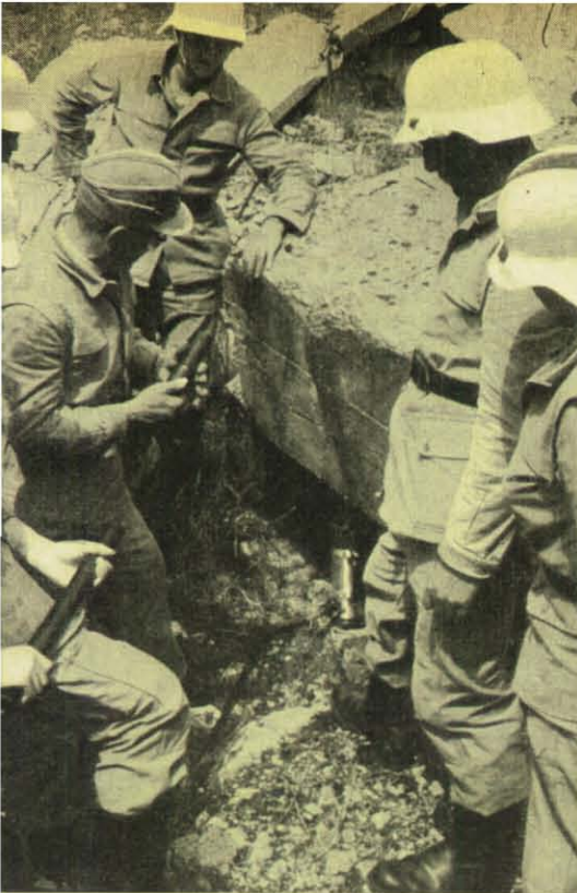
Die praktische Handhabung der schweren Bergungsgeräte kann nur im Übungsgelände, am „Objekt“, erlernt werden. Der Öldruckheber, „Lukasheber“, bewegt Lasten bis 40 t.
