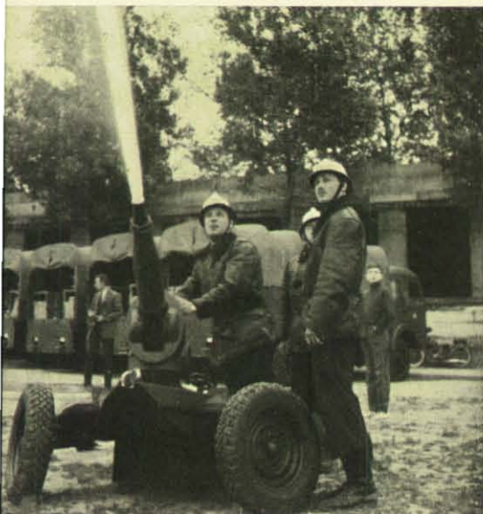
Die Wassermenge von fünf R-Schläuchen wird in dieser französischen Wasserschleuderkanone zusammengefaßt, die sich bei vielen Einsätzen schon ausgezeichnet bewährt hat.
