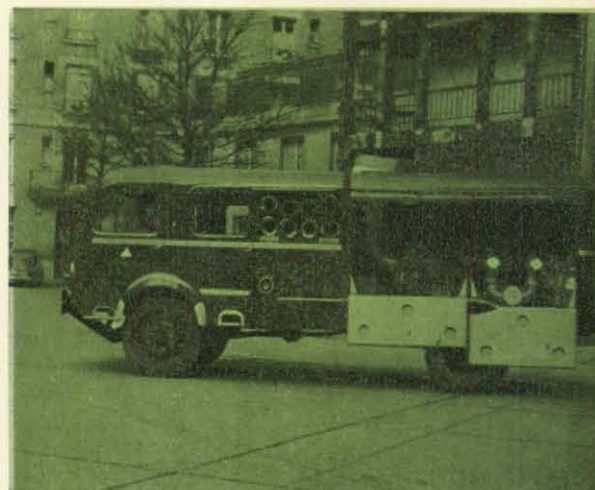
Viele Löschfahrzeuge in Frankreich sind mit Luftturbinen ausgerüstet. Die Pumpe eines solchen Fahrzeuges leistet 550 m 3 Wasser pro Stunde bei einer Saughöhe von 1,50 Metern.
