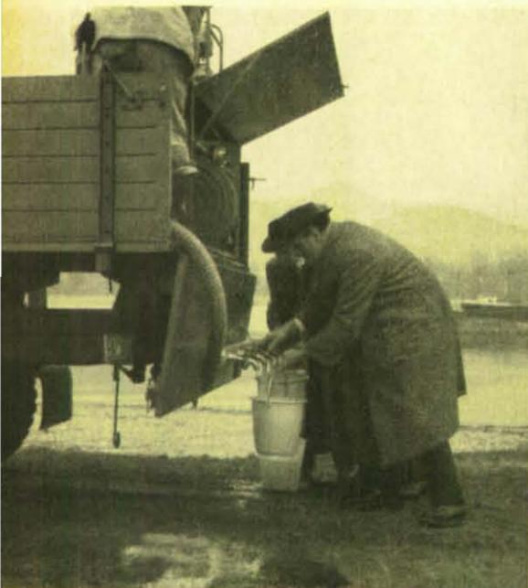
Nicht nur zur Notversorgung der Bevölkerung mit Trinkwasser ist dieses Fahrzeug geeignet, sondern sein Wasservorrat kann mit Hilfe einer Motor-Tragkraftspritze zur Bekämpfung von Bränden eingesetzt werden.
