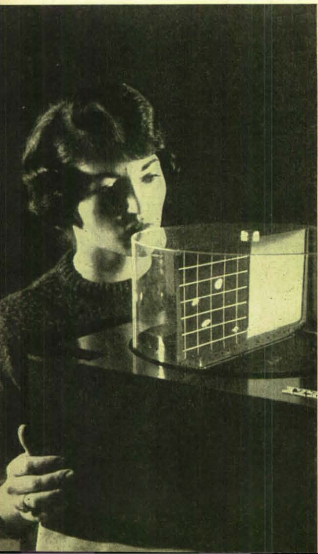
„Dreidimensional“ fängt dieses neue Elektronengerät das Radarecho ein. Die Lichtpünktchen im Planquadrat lassen eine rasche und sichere Ortsbestimmung für Flugzeuge, Raketen, Satelliten und auch für U-Boote zu.
