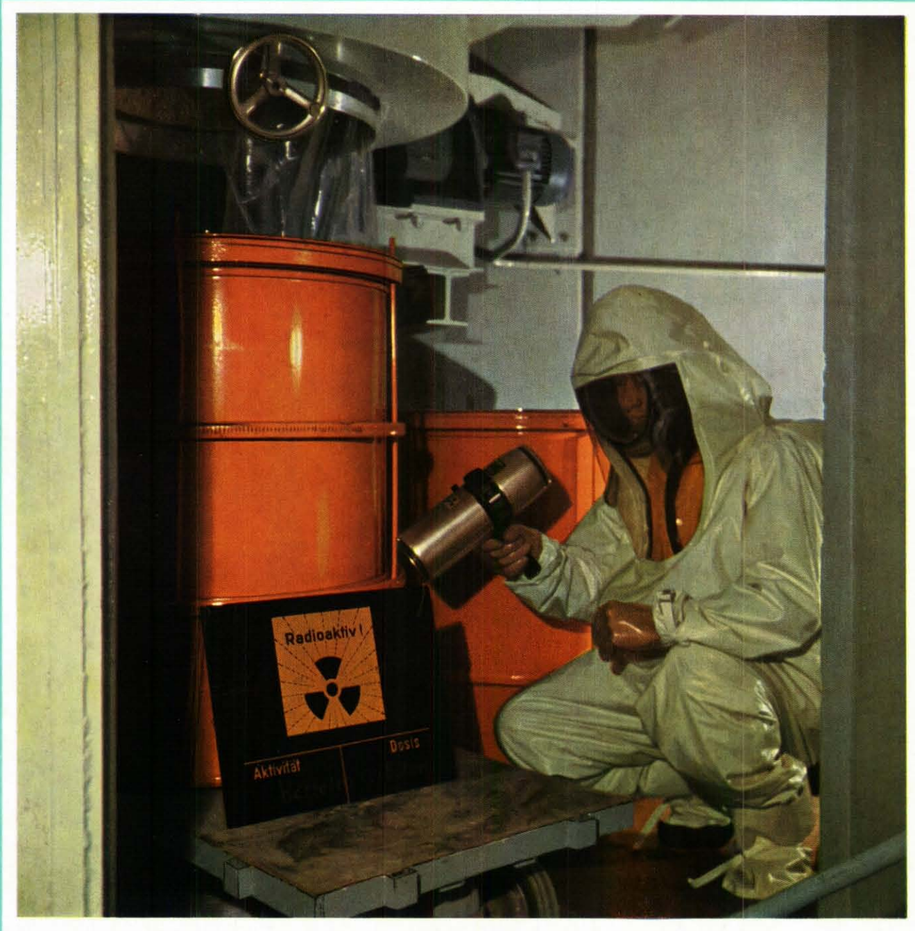
So werden im Karlsruher Atomforschungszentrum radioaktive Schlämme abgefüllt. Der Operateur trägt dabei einen luftdichten Spezialanzug. (Zu unserem großen Bericht auf den Seiten 10-14)
