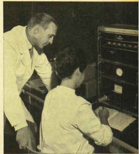
Oben: Das im Isotopen-Laboratorium des Instituts benutzte Strahlungs-Meßgerät FH 49 ist ein kombiniertes Zähl- und Integriergerät mit automatischer Steuerung. Unten: Radioaktive Isotope für wissenschaftliche Arbeiten sind strahlungssicher in Tresor und Bleiblock untergebracht.
