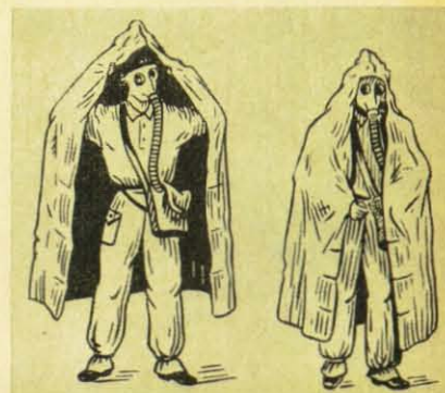
Bild oben: Schutzkombination mit Überzug aus wärmeableitender gebleichter Baumwolle. Die Schutzumhänge (Bild unten) sind aus einem Spezialmaterial gefertigt.
