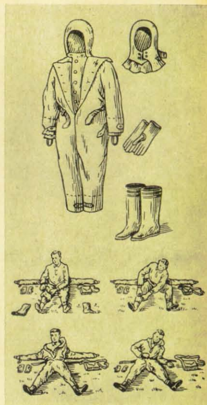
Anlegen einer Schutzkombination gegen radioaktive Stäube sowie chemische und biologische Kampfstoffe.
