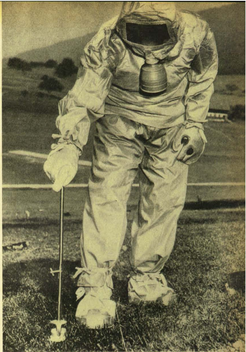
Zur Abwehr chemischer Kampfstoffe ist es notwendig, die Art der eingesetzten Mittel schlüssig zu ermitteln. Unser Bild zeigt die Probenentnahme eines chemischen Kampfstoffes aus verseuchtem Gelände. An dem Schutzanzug, mit dem die Entgiftungstruppe ausgerüstet sind, fällt besonders die Bändersicherung auf, die das Eindringen der äußerst gefährlichen Kampfmittel unter die Kleidung verhindern soll. ▲
