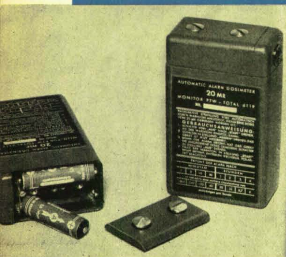
Abb. 4: Alarmdosimeter Typ „PTW-Total 6119“ (Total-Gerätebau KG, Ladenburg/Neckar)
