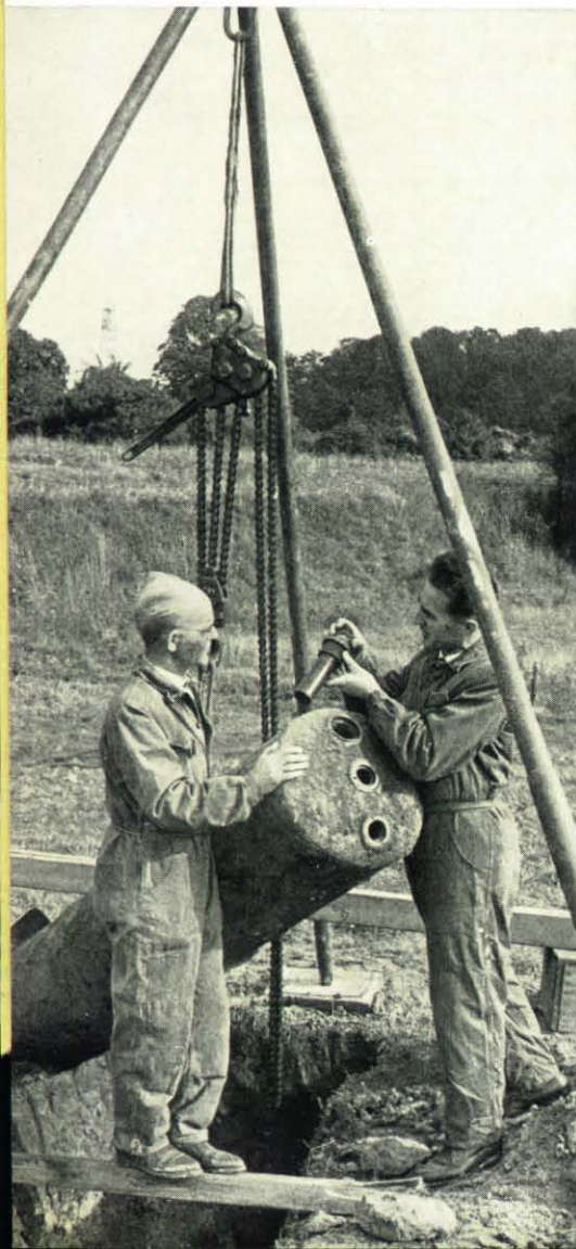
◀ Links: In Mönkeberg bei Kiel entschärfte die Munitionsräumgruppe eine 20 Zentner schwere Luftmine britischer Herkunft aus dem 2. Weltkrieg durch Ausbau der drei Zünder.
