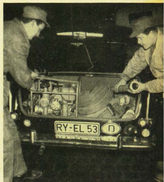
Oben links: THW-Helfer tragen ein Notstromaggregat an die Einsatzstelle. Oben rechts: Als die Flut abgelaufen war und die Abwasserkanäle wieder Wasser aufnahmen, setzte die Feuerwehr alle verfügbaren Pumpen zum Entleeren der Keller ein. Links: BLSV-Helfer beim nächtlichen Einsatz. Hier wird der Saugvorgang gerade unterbrochen, weil sich das Sieb der Kreiselpumpe der TS 2/5 durch die im Wasser schwimmenden Fasern der Sandsäcke wieder zugesetzt hat.
