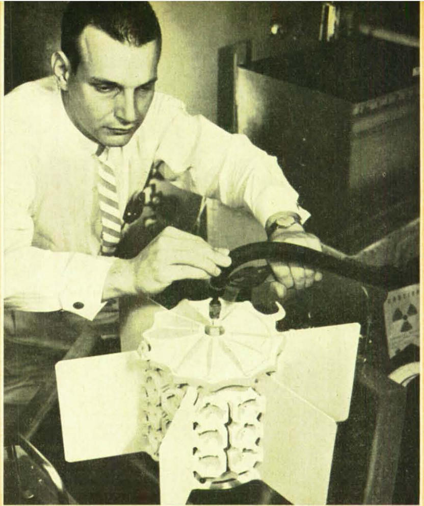
Links: Die ATLAS-CENTAUR ist die erste amerikanische Rakete, in der Flüssigwasserstoff als Treibstoff benutzt wird. Rechts: Montage an SNAP 9. Dieses Gerät liefert den Betriebsstrom für Erdsatelliten im Flug.
