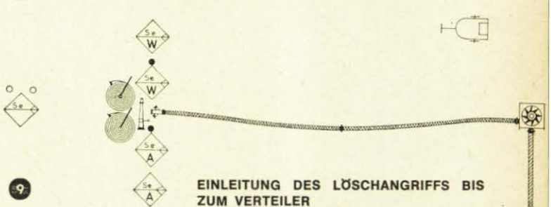
„ZUM EINSATZ FERTIG“ WASSERTRUPP verlegt Saugleitung ANGRIFFSTRUPP steht nach Verlegen der Zubringer- leitung links vom Verteiler bereit MASCHINIST startet TS 2/5 und saugt an
