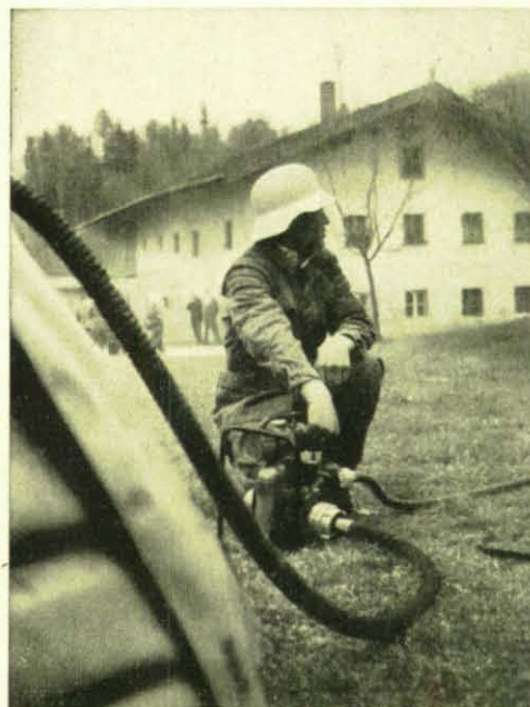
Die TS 05/4 dient in erster Linie zur Ausrüstung von Löschtrupps der Betriebe des Erweiterten Selbstschutzes und des Behördenselbstschutzes. Unser Bild zeigt sie in einem übungsmäßigen Einsatz.
