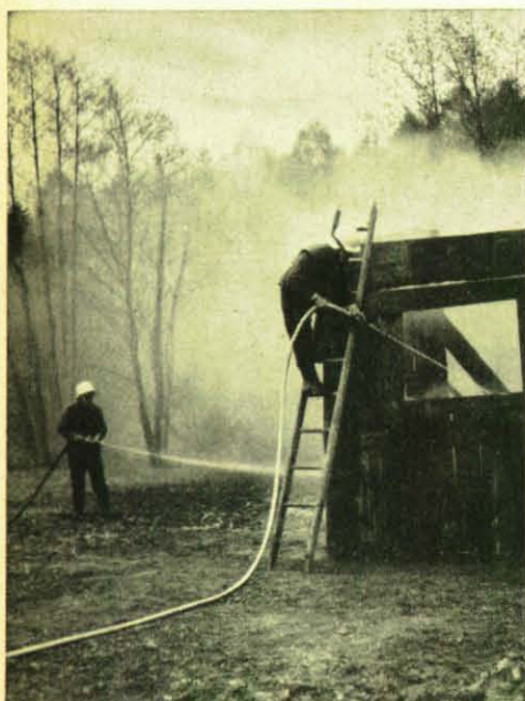
Die Löschkraft der TS 05/4 reicht aus, um Entstehungs- und Kleinbrände wirksam zu bekämpfen. Die TS kann zwei D-Strahlrohre gleichzeitig speisen.
