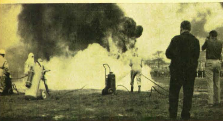
Ein schwerer Ölbrand wird mit zwei fahrbaren Pulverlöschgeräten mit je einer Füllung von 50 kg in Sekundenschnelle gelöscht.
