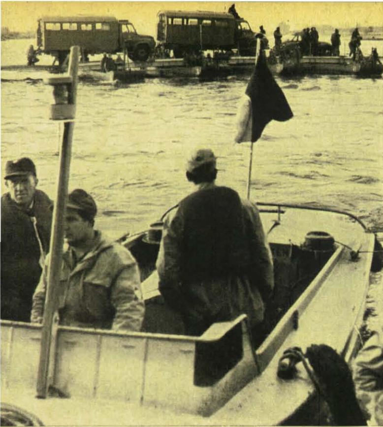
Das schwere Drückboot, das zwischen den beiden mittleren Pontons der Fähre befestigt ist, schiebt die 8-Tonnen-Last der Fahrzeuge mühelos über den Rhein-Strom. Der Fährverkehr von Ufer zu Ufer ist in vollem Gange.
