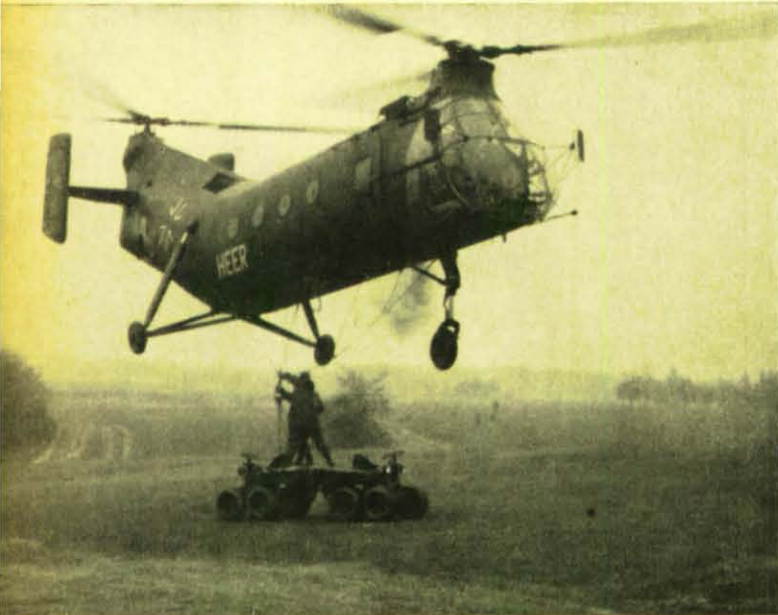
Unten: Keine Sensation mehr, aber immer wieder interessant: Transport von Fahrzeugen durch Hubschrauber. Hier sind es zwei „Kraka“!
