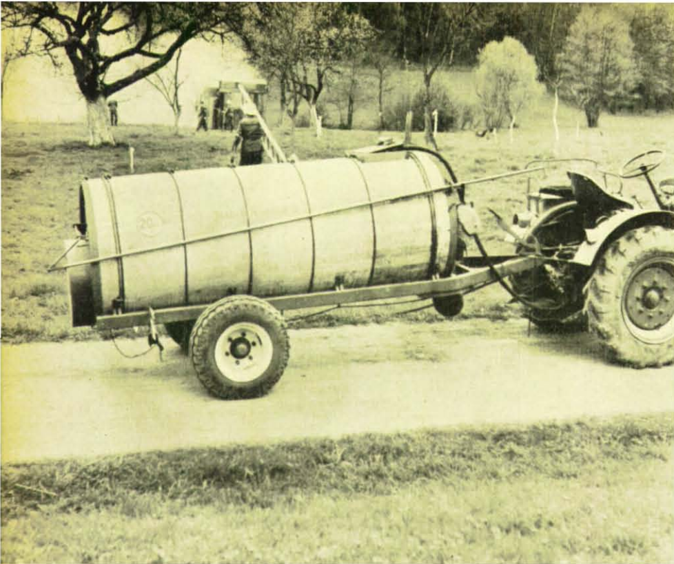
Wasser- oder Jauchefässer in Verbindung mit Zapfwellenpumpen finden in der Landwirtschaft vielfältige Anwendung. Auch als Löschgerät ist diese Kombination bestens geeignet.
