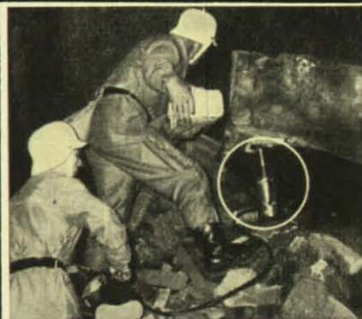
bei allen Arbeiten, die hohe Druck- oder Zugkraft erfordern. Universal-Hydro-Werkzeuge LUKAS in Leichtmetallausführung mit Druckkräften bis zu 200 t arbeiten mit 450 at Betriebsdruck. Deshalb sind sie klein, leicht und handlich.
