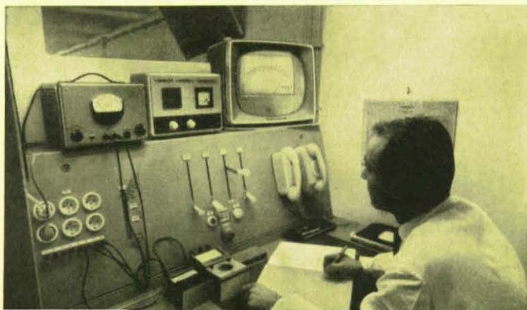
Von diesem zentralen Bedienungspult aus erfolgt die Steuerung der Präparate, wodurch die stufenlose Messung der Gammastrahlung ermöglicht wird. Zur Sicherheit der hier Beschäftigten wurden alle Schutzmaßnahmen getroffen.
