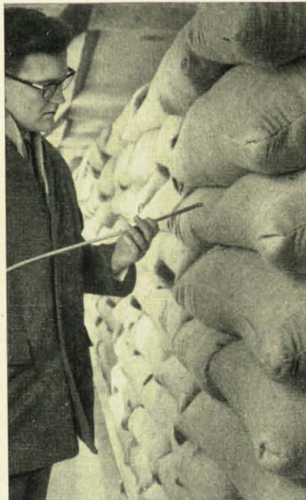
Sackware, z. B. Hülsenfrüchte oder Zucker, wird gern von Schädlingen heimgesucht. Sie bedarf daher besonders sorgfältiger laufender Kontrolle. Mit dem auf unserem Bild erkennbaren Spezialthermometer wird die Temperatur im Innern der Stapel gemessen.
