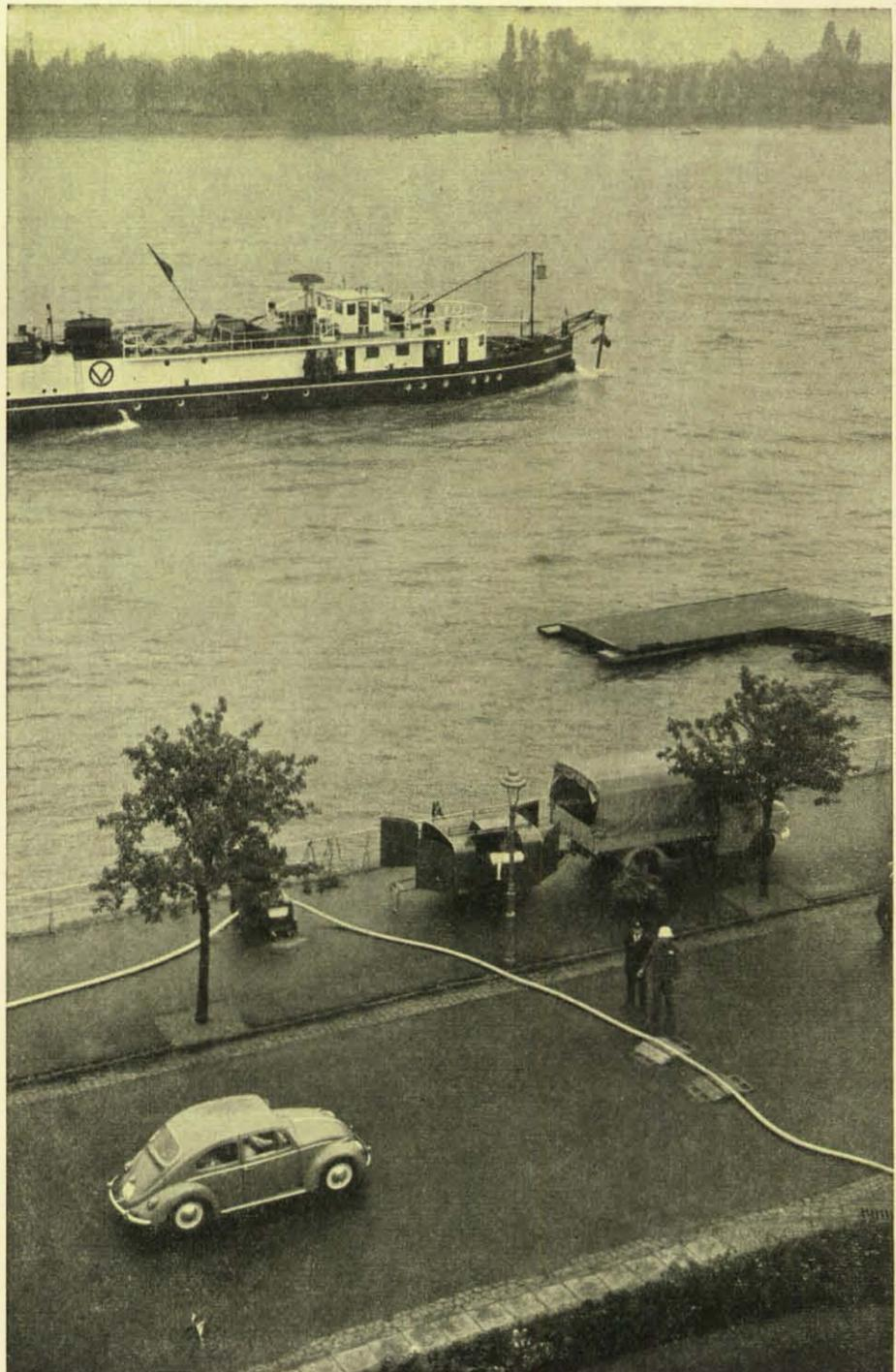
Auf dem Bild links schließen zwei Helfer die C-Druckschläuche an die Trockensteigeleitung an. Das Bild rechts vermittelt einen Überblick, wie die TS 8/8 am Rhein zur Wasserentnahme in Stellung gebracht ist. Die Schlauchleitungen werden durch hölzerne Schlauchbrücken geschützt, so daß Kraftfahrzeuge die Leitung überfahren können, ohne sie zu beschädigen.
