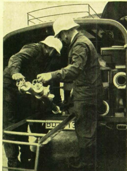
In dem Tragkraftspritzenanhänger der Löschgruppen sind u. a. fünf B-Druckschläuche und ein C-Druckschlauch untergebracht. Mit nur wenigen Handgriffen ist das notwendige Gerät dem Anhänger zu entnehmen.
