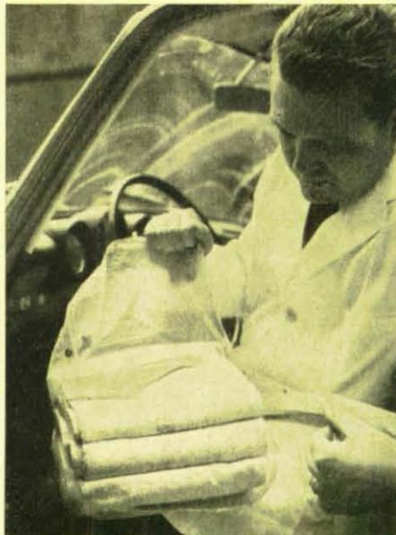
Ein Griff, und der nur mit Druckknöpfen verschlossene Kunststoffbeutel ist geöffnet. Feuerlöschdecken werden heute schon von vielen Kraftfahrern zur Bekämpfung von Bränden bei Unfällen im Fahrzeug mitgeführt. Sie eignen sich zum Löschen von Benzin-, Reifen-, Polster- und Lackbränden.
