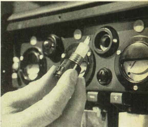
Auswechseln einer Sicherung am vollautomatischen Ladegerät.
