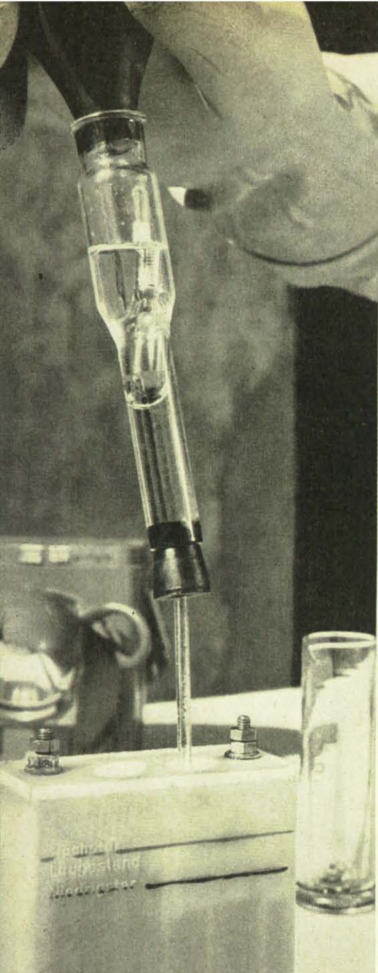
Mit Hilfe des Aräometers, der innerhalb des Saughebers schwimmt, wird die Dichte der Kalilauge bestimmt.
