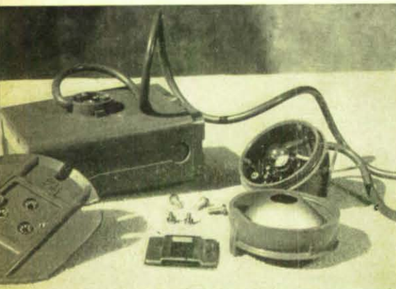
Für die regelmäßige Wartung sind die Teile einer Kopf-Hand-Leuchte auseinandergenommen worden.
