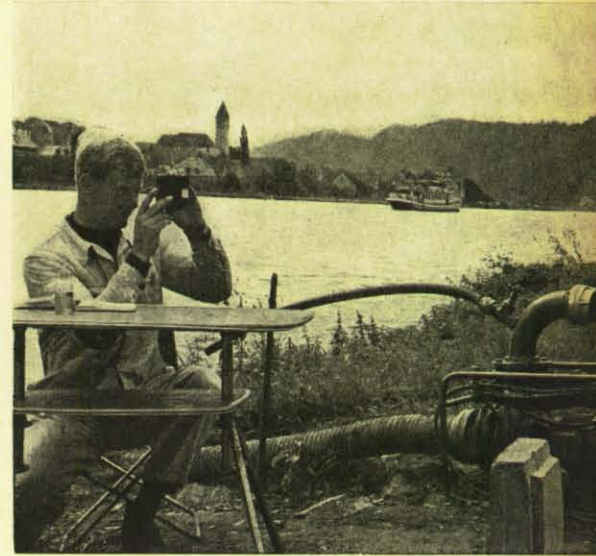
Bild 6: Der Gehalt an Chlor im Trinkwasser wird laufend kolorimetrisch (durch farbvergleichende Messungen) bestimmt und in einem Protokollbuch aufgezeichnet. Die Chlorbestimmung ist einfach durchzuführen und kann von jedem Laien nach kurzer Einweisung vorgenommen werden. Im Vordergrund des Bildes sieht man die Pumpe, die das Oberflächenwasser (hier Moselwasser) in die Wasseraufbereitungsanlage befördert.
