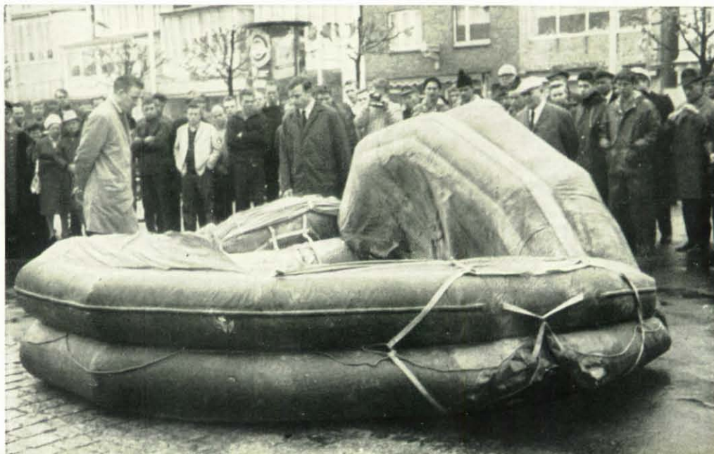
Eine hanseatische Rettungsgeräte-Fabrik führt eine von ihr entwickelte Rettungsinsel vor. Unser Bild oben zeigt die sichere Lage der „Insel“ auf dem Wasser. Bild unten: Interessiert beobachten die Zuschauer, wie sich die Rettungsinsel automatisch aufbläst. Sie ist in 30 Sekunden rettungsbereit.
