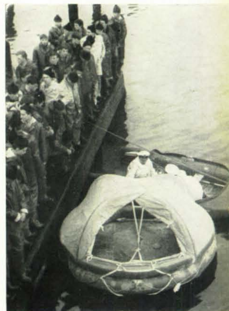
Eine hanseatische Rettungsgeräte-Fabrik führt eine von ihr entwickelte Rettungsinsel vor. Unser Bild oben zeigt die sichere Lage der „Insel“ auf dem Wasser. Bild unten: Interessiert beobachten die Zuschauer, wie sich die Rettungsinsel automatisch aufbläst. Sie ist in 30 Sekunden rettungsbereit.
