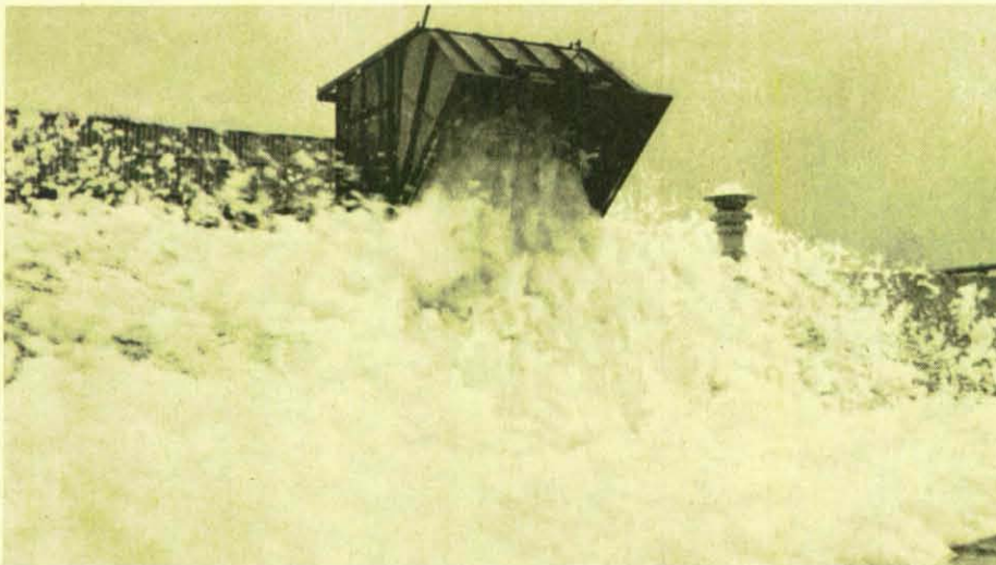
Oben: Der Leichtschaum ergießt sich in ununterbrochener Folge in das Becken. Ölbränden u. dgl. wird der Sauerstoff entzogen — sie „ersticken“.
