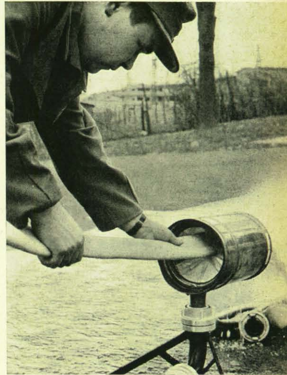
Schlauchwaschapparat aus einem zylindrischen Blechkörper. Durch den Wasserstrahl wird der Schlauch gereinigt und weiterbefördert.
