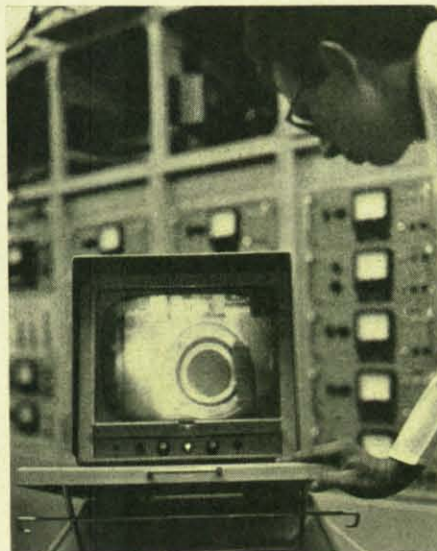
Fernsehgeräte ermöglichen die Überwachung automatischer Vorgänge aus strahlensicheren Räumen.
