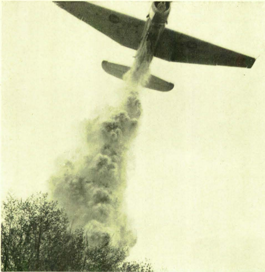
Auch mit Löschpulver kann gegen kleinere Waldbrände angegangen werden. Ein Flugzeug vom Typ „Avenger“ beim Abwurf von Bentonite-Pulver.
