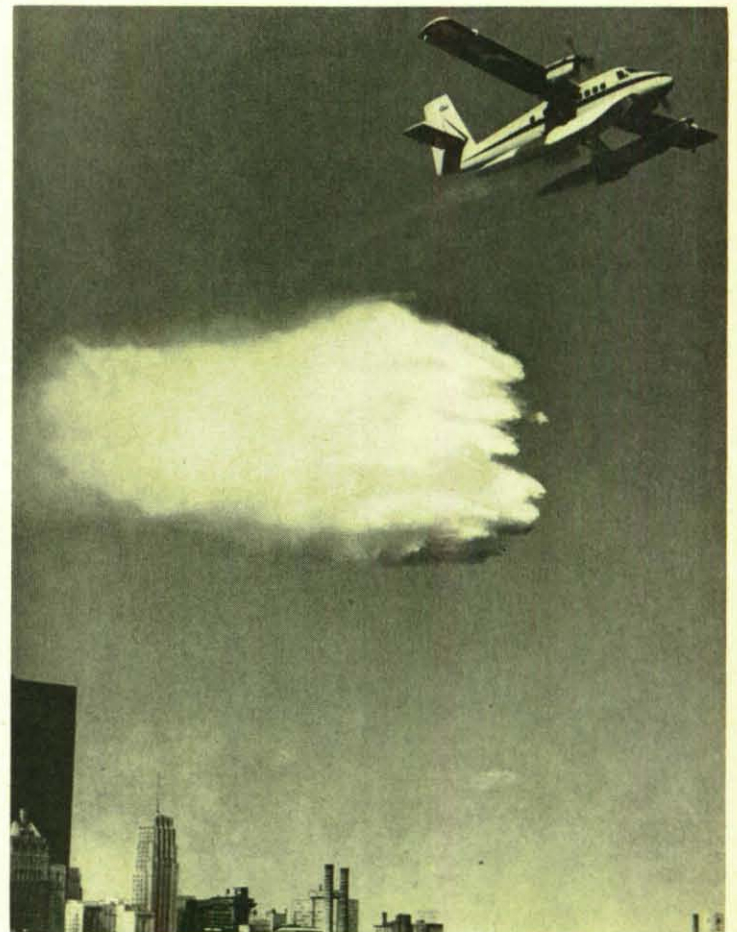
Bild rechte Seite oben: Flugboote — hier eine „Canso“ — füllen ihre Tanks beim Wassern auf einem Fluß oder See und lassen es im Überflug über dem Brand ab. Durch den Fall wird die Wassermenge verteilt und schlägt wie eine riesige Feuerpatsche auf den brennenden Wald.
