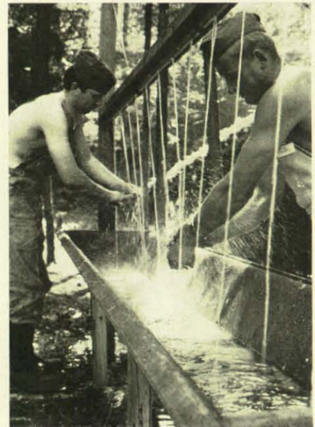
Oben: Eine im Freien errichtete einfache Waschanlage, deren Rinne mit Dachpappe ausgeschlagen ist, erfüllt ihren Zweck.
