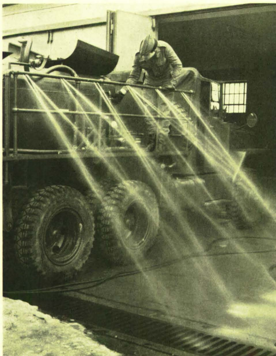
Unser Bild zeigt ein vielseitig verwendbares Dekontaminierungs-großgerät für Wassertransport, Duschen von Personen, Herstellung und Verteilung von Dekontaminierungsflüssigkeiten.
