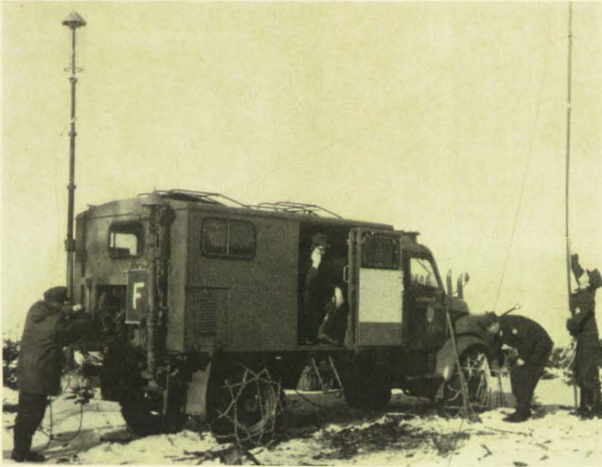
Oben: Ein Funkgruppenfahrzeug übernimmt, auf günstiger Höhe eingesetzt, die Aufgaben einer Relaisstation im Sprechfunkbetrieb.
