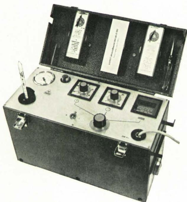
Zur Messung von Gaskonzentrationen in der Luft hat sich das Gasspüren mit Prüfröhrchen millionenfach bewährt. Diese Prüfröhrchen gibt es für über 100 verschiedene Gase und Dämpfe. Normalerweise wird die zu untersuchende Luftprobe mit der Balgpumpe des Gasspürgerätes durch das Röhrchen gesaugt, wobei meist weniger als 1 Liter Prüfluft (= 10 Saughübe) benötigt wird. Enthält die Luftprobe die vermuteten gasförmigen Bestandteile, verfärbt sich das Röhrchen zonenweise. An
