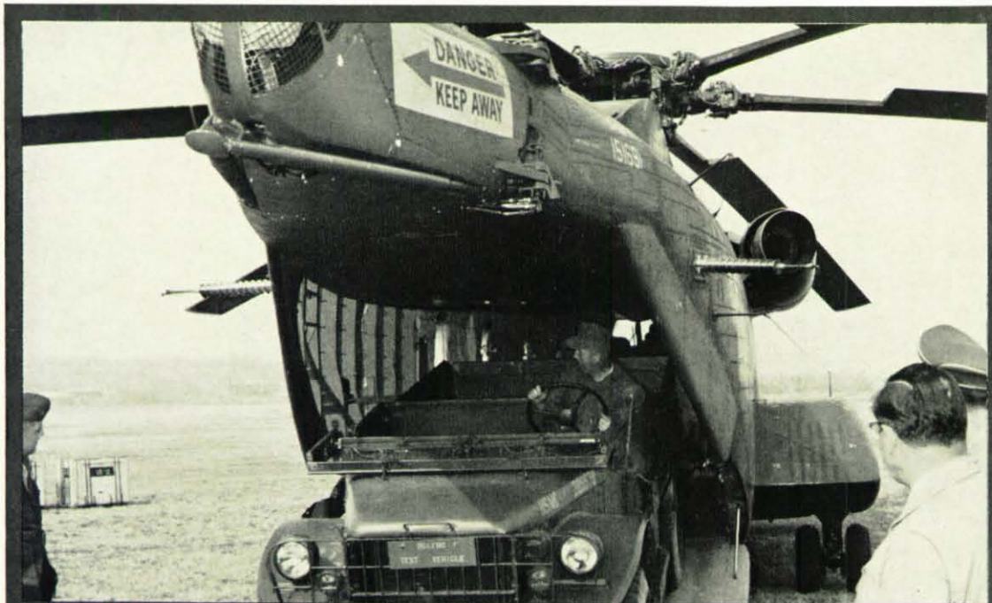
Links: In dem großen Laderaum mit Heckrampe lassen sich auch größere Fahrzeuge wie dieser 1,5-t-Lkw unterbringen.
