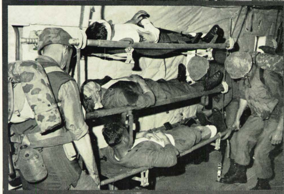
Oben: Mit Hilfe eines Gurtsystems kann die CH-53 in Minuten in einen Transporter für Verletzte umgewandelt werden. Es finden 24 Tragen Platz. Vom Mittelgang aus können die Sanitäter die Patienten versorgen.
