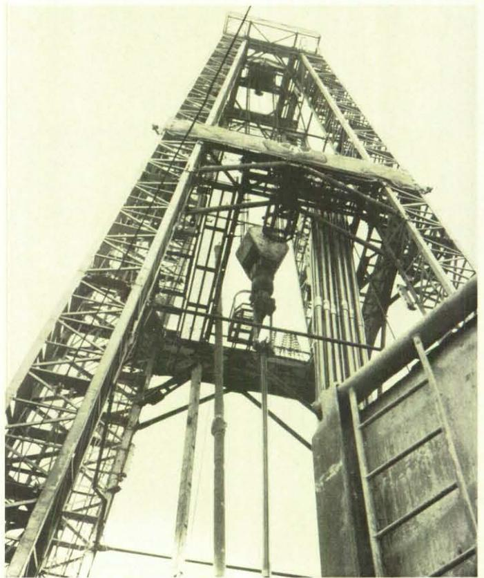
Das gewaltige Hebezeug in der Mitte des Bohrturms senkt Rohr auf Rohr in die Erdrinde, in die zuvor Bohrmeißel aus Hartstahl sich tief hineingefressen haben. Das dabei zermalmte Gestein wurde fortgespült.
