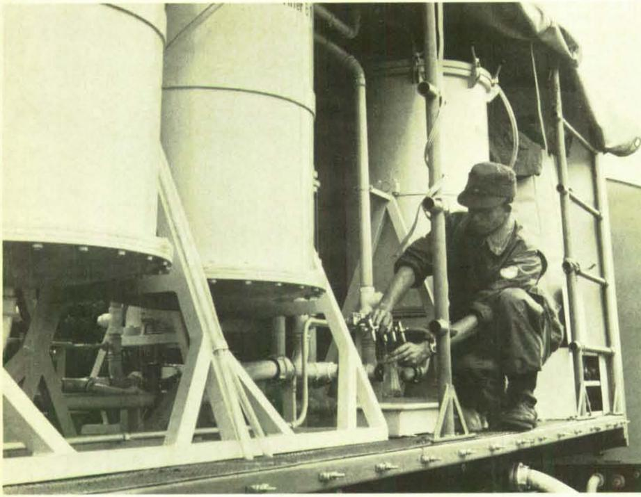
Eine echte Katastrophenschutzaufgabe ist die Bedienung dieser Wasser-aufbereitungsanlage, die, auf einen Anhänger montiert, schon einige echte Einsätze hinter sich hat.
