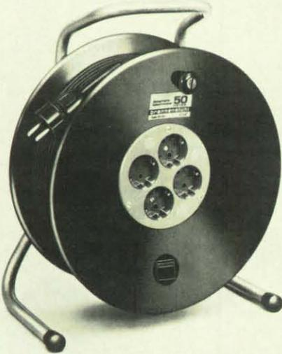
3-Punkt-Handgriff ist so angeordnet, daß die Trommel beim Tragen Abstand vom Körper hält. Eine Spezialbremse kontrolliert das Abrollen des Kabels. Die Kabeltrommel, die bis zu 75 m Kabel aufnehmen kann, hat vier Steckdosen, alle praktisch an einer Seite angeordnet.
