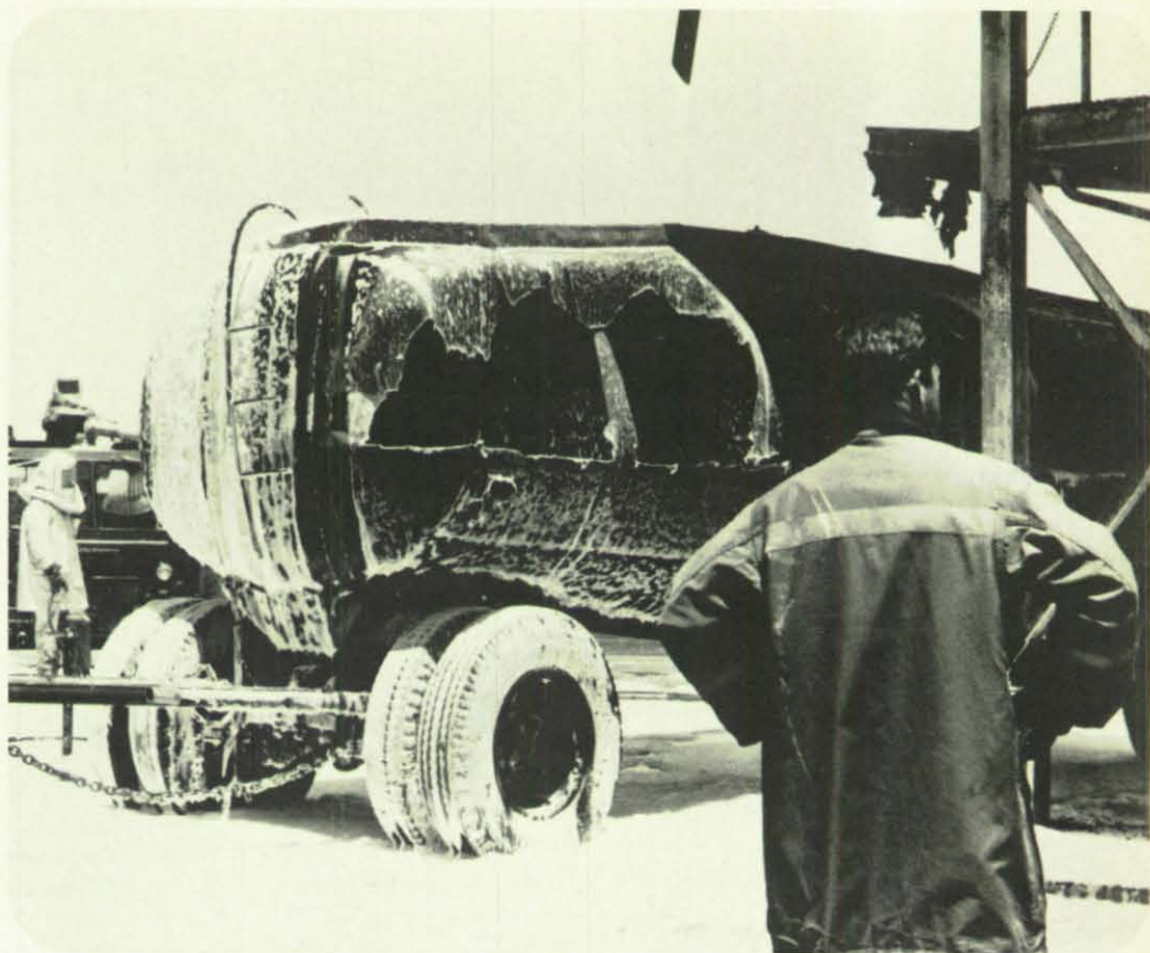
Dieses Foto zeigt einen ausgebrannten Tankwagen, dessen Metallbehälter durch die Hitze teilweise geschmolzen ist, dessen Gummibereifung aber infolge des Löscheinsatzes intakt geblieben ist.
