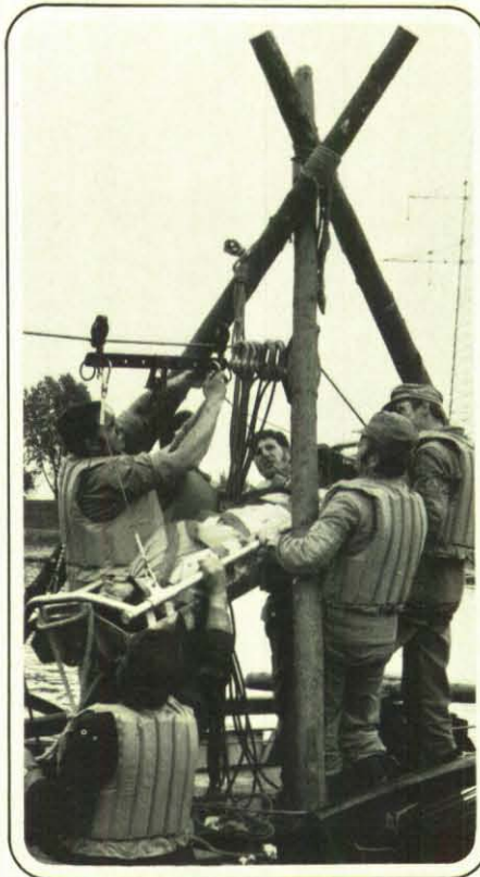
Den schiffsseitigen Befestigungspunkt für die Seilbahn, über die der Transport mit dem Schleifkorb erfolgte, bildete dieser Dreibock. An Land war es ein in Zugrichtung stehender Lastkraftwagen der Hilfsorganisationen, die vom Ufer aus den Einsatz an Bord unterstützten.
