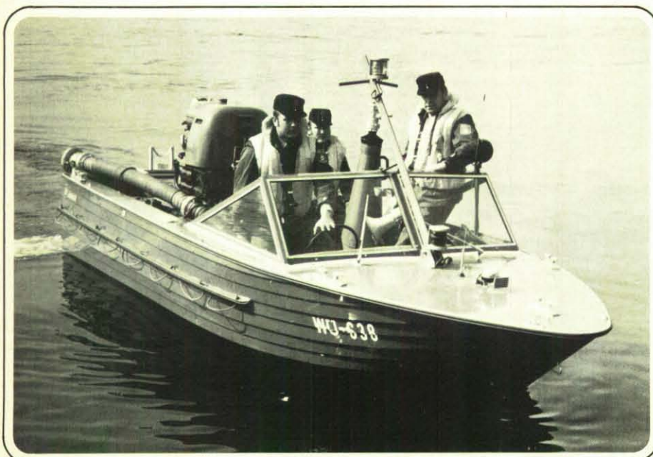
In Zukunft soll dieser Typ eines Katastrophenschutzbootes zusammen mit zwei Arbeitsbooten auf je 30 km Flußstrecke stationiert werden. Das Kunststoffboot hat Jet-Antrieb.
