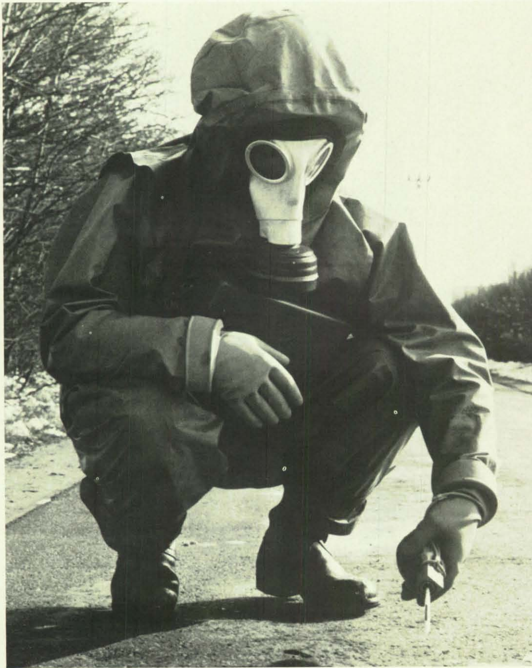
Die Gasspürpumpe mit Meßröhrchen im Gebrauch durch Helfer im ABC-Dienst
