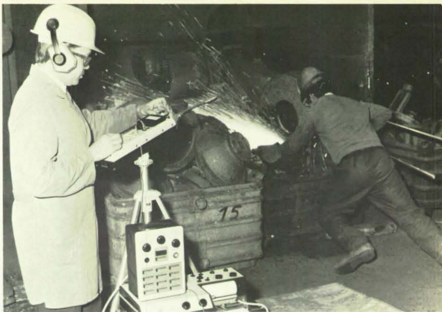
Das neue „Berufsgenossenschaftliche Institut für Lärmbekämpfung“ fahndet mit modernsten Geräten nach üblen Lärmquellen. Ein Meßtechniker kontrolliert hier den Lärmpegel einer Pendelschleifmaschine mit einem Impuls-Schallpegelmesser mit angeschlossenem Oktavfilter.
