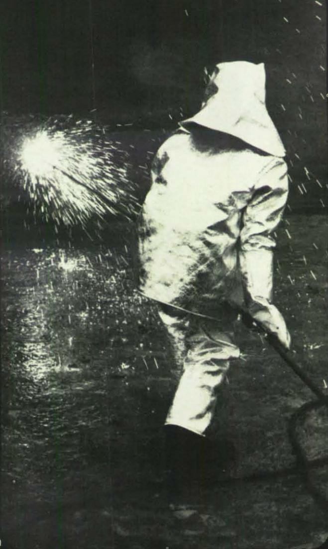
Auch im Technischen Hilfswerk, z. B. bei der Anwendung der Sauerstofflanze (unser Bild) schützen sich die Helfer gegen Strahlungshitze und Funkenflug durch Anzüge oder Mäntel aus einem metallisch-reflektierenden unverbrennlichen oder schwer entflammbaren Material.
