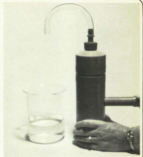
Behälter aus leichtem Kunststoff, der etwa die Größe einer Sektflasche hat, wird mittels einer seitlichen Handpumpe im Innern ein Überdruck erzeugt, der das verunreinigte Wasser über ein Steigrohr durch eine Filterkombination drückt, wo das Wasser völlig gesäubert wird. Gutachten anerkannter Institute bestätigen dies. Die Filter sind auswechselbar. Je Filter gibt es ca. fünf Liter sauberes Wasser.
