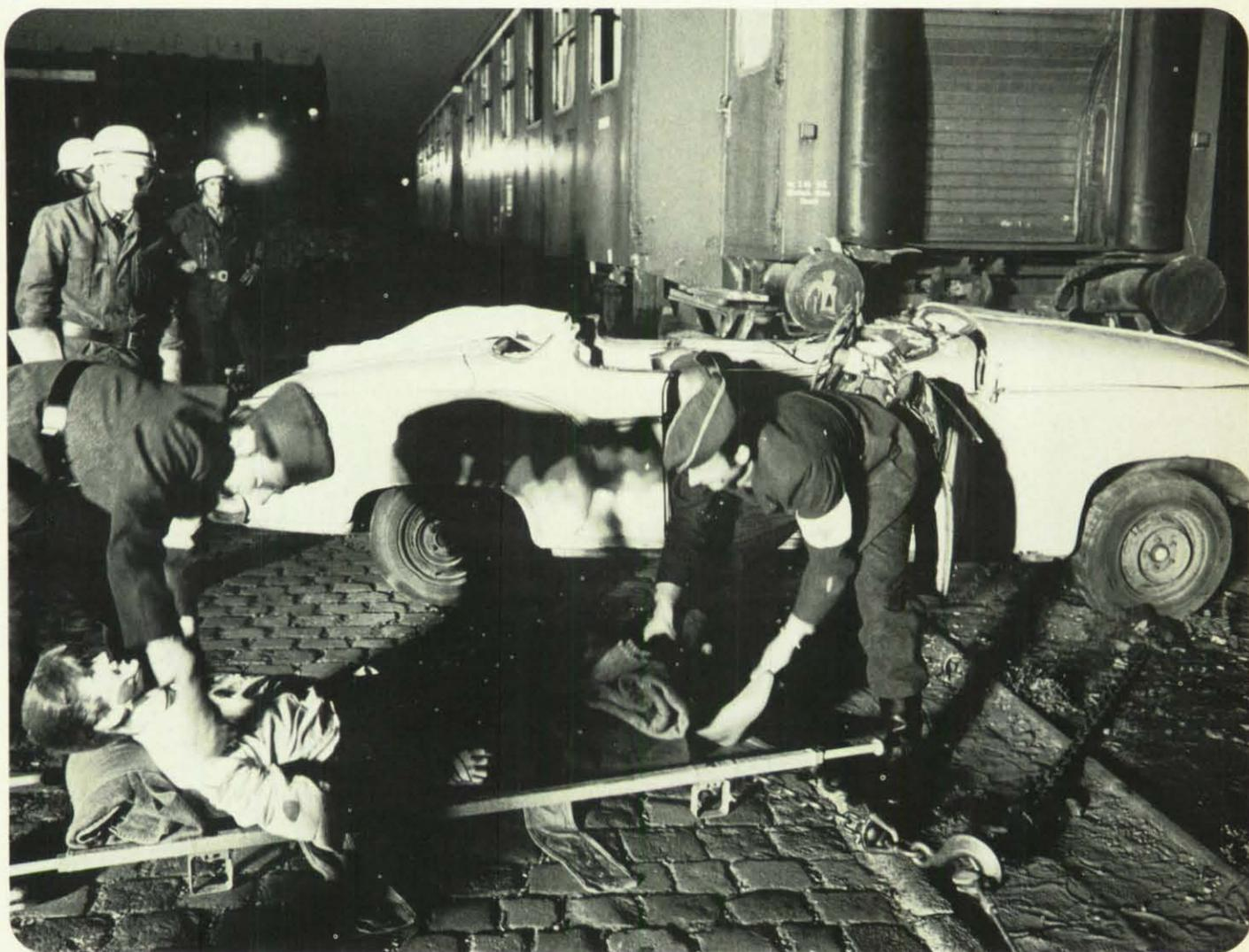
**Vorziehen des PKW mit einer Seilzugwinde, Abtrennung der Überdachung und Bergung des Fahrers.**
