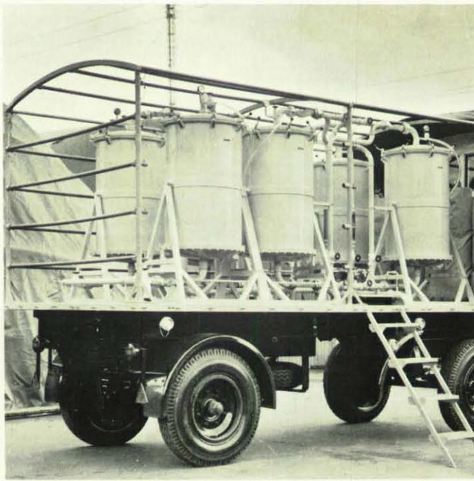
**Die von einem westdeutschen Unternehmen entwickelte Entölungsanlage leistet in Fällen ölverseuchten Wassers wirksame Hilfe. Die abgebildete Ausführung kann stündlich bis zu 10 000 Liter Wasser vom Öl befreien.**
