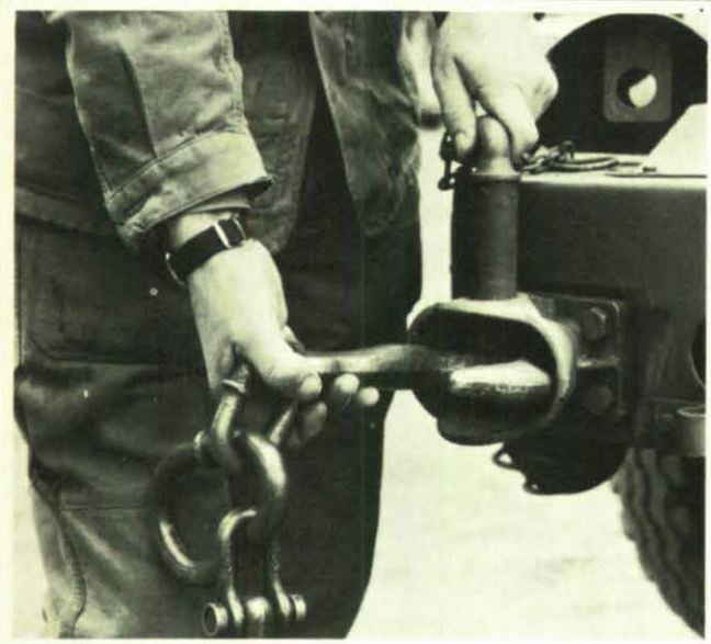
Dieser Ösenhaken einer Zugkette läßt sich nicht mit der Abschleppvorrichtung am Kraftfahrzeug verbinden, weil die Größenverhältnisse nicht stimmen.
