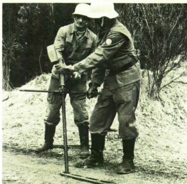
Die Nägel sind in Verbindung mit Schäkeln, Anschlagstück usw. als Einzelverankerung zu gebrauchen, z. B. beim Bewegen von Lasten wie Trümmer oder Bäume oder beim Flottmachen festgefahrener Fahrzeuge.
