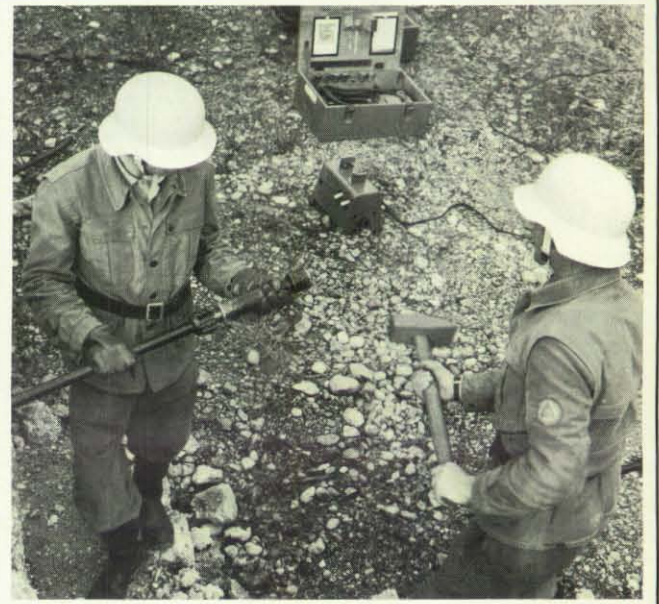
Baut man den Bohrhämmer um, kann man den Erdankernagel einsetzen und erhält so einen provisorischen Aufreißhammer. Auch dies ist ein Beweis für die vielseitige Verwendbarkeit.
