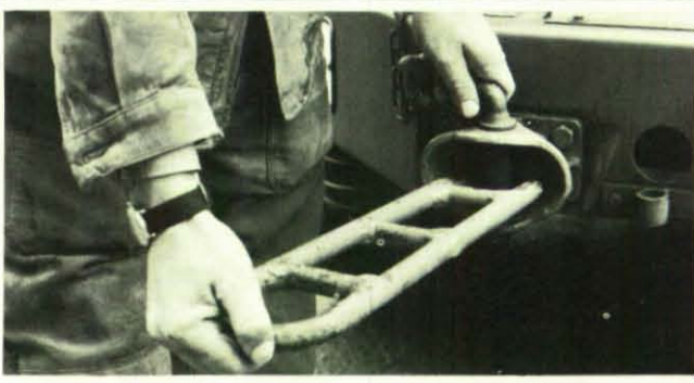
Ein dazwischengeschaltetes Anschlagstück, auch eine Entwicklung der Katastrophenschutzschule Wolftrathausen, kann das Abschlepp-Problem lösen.
