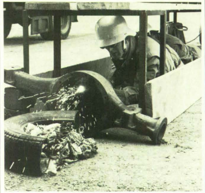
Auch ein Vorschlag: Ein gut einzusehender Kriechgang aus Schweißtischen und Bohlen zum Üben von Brennschneiden unter erschwerten Bedingungen.
