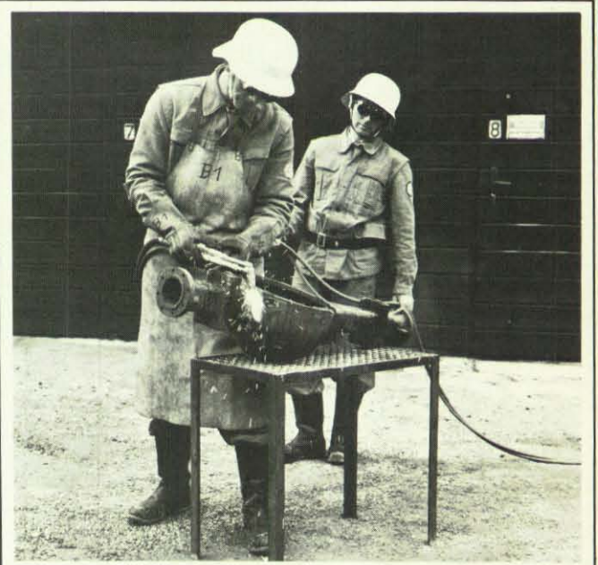
Das Foto zeigt einen Schweißstisch aus einem Fußabstreifrost und einigen Winkeleisen; schnell hergestellt und praktisch.
