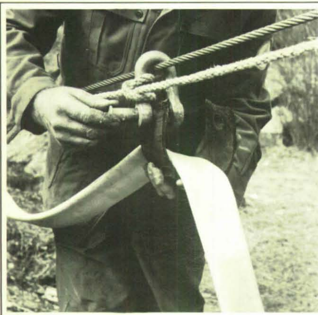
Verwenden lassen sich die Segmente aus alten Autoreifen auch für den Bau von hängenden Wasser- oder Mineralölförderleitungen oder als Kabelbündel-Überweg.
