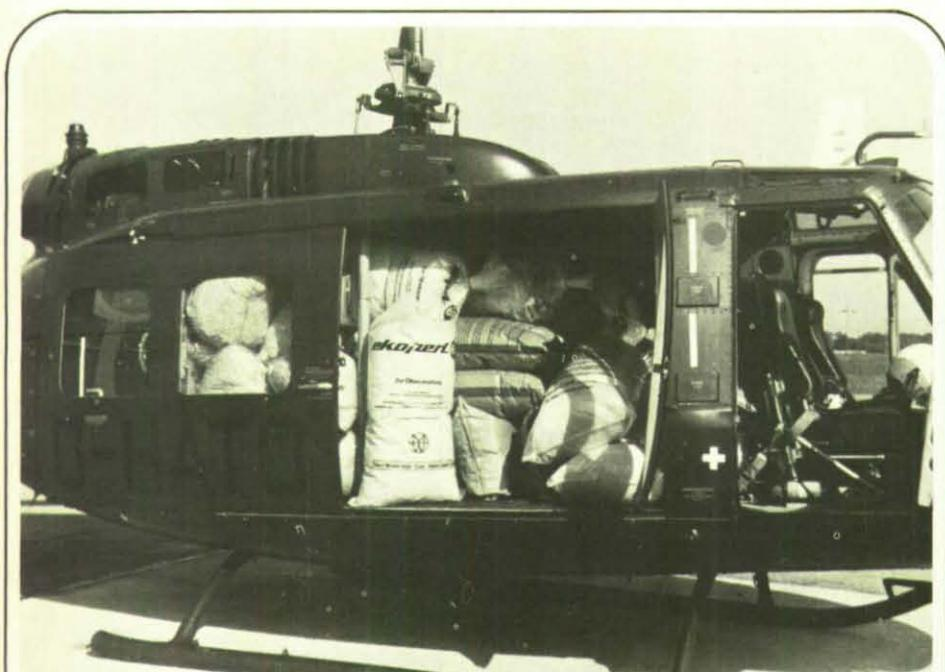
Ein mittlerer Transporthubschrauber kann in einem Arbeitsgang 4 cbm = 40 Säcke à 100 l Ölbinde aufnehmen. Selbstverständlich muß das Abwurfpersonal durch Gurte gesichert werden.
