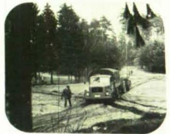
Verhältnismäßig leicht kann man ein festgefahrenes Fahrzeug mit Hilfe einer Seilwinde freibekommen. Doch auch dabei muß der Fahrer Sorge treffen, daß die enormen Kräfte der Seilwinde bei unsachgemäßer Behandlung und Anwendung keine Schäden anrichten. Bei dieser Arbeit darf der Fahrer auch nicht vergessen, daß haltende und liegende Fahrzeuge gesichert und der andere Verkehr gewarnt werden muß.
