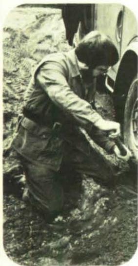
Es gibt eine Reihe von Hilfsmitteln, um stecken gebliebene Kraftfahrzeuge wieder flott zu machen. Der Helfer sollte sie kennen und praktisch erproben. Oft genügt es, die Fahrspur freizuschaukeln oder Bohlen, Strauchwerk, Steine, Stroh oder Maschendraht vor die Räder zu legen. Genügt eines der Hilfsmittel nicht, muß er versuchen, mehrere Hilfsmittel gleichzeitig anzuwenden.
