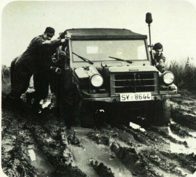
Bei der Überwindung von schlammigen Wegen geht es oft nicht ohne die Anwendung einiger Tricks und Kniffe. Z. B. kann man das Gewicht des Fahrzeugs durch Absitzen der Besatzung oder Entladen toter Nutzlast erleichtern. Vor dem möglichen Steckenbleiben sollte die Besatzung Schiebehilfe geben.
