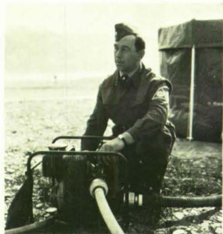
Umpumpen des vorgeflockten Rohwassers in die Filteranlage.
