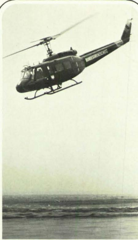
Bei den Versuchen ging es auch darum, die Beeinflussung des ausgetragenen Ölbinders durch die Rotor-Luftströmung festzustellen bzw. zu testen, wie tief der Hubschrauber die Wasserfläche überfliegen soll.
