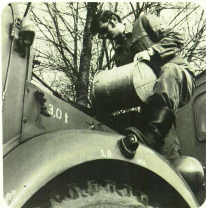
Das, was der Fahrer mit seinem Privat-PKW an der Tankstelle machen läßt, muß er hier selbst tun, nämlich Motorenöl wechseln oder ergänzen. Hier lernt er auch, wie ein Vergaser gereinigt wird, wie man schadhafte und verschmutzte Zündkerzen feststellt und auswechselt, wie der Leer-
