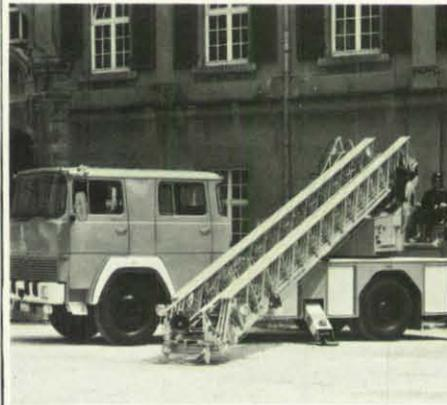
Fahrbahnniveau des Fahrgestells „F Magirus 170 D 12 F“ gesenkt werden. Im Gegensatz zu den bekannten 30-Meter-Drehleitern läßt sich die neue „DL 30“ auch vier Meter weiter, nämlich bis zu 26 Metern bei aufgelegter Leiter, in der Horizontalen ausfahren. Hinzu kommt eine neuartige Seiteneinstellung für die Vertikale, die bei jedem Aufrichtwinkel der Leiter voll wirksam wird, sofern das Fahrzeug gezwungen ist, schräg zu stehen.
