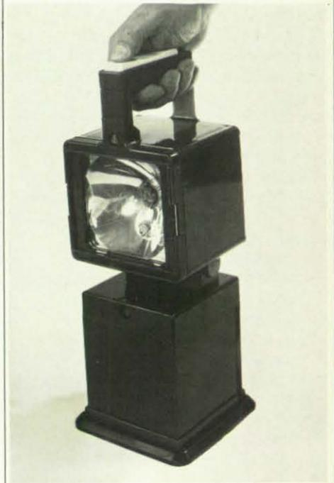
15 Sekunden. Als Stromquelle dient eine Batterie, bestehend aus vier gasdichten Ni-Cd-Akkumulatoren. Bei Normallicht (mit Glühlampe 5 V, 5 W) beträgt die ununterbrochene Brenndauer ca. 6 Stunden. Eine Ladevorrichtung (Kondensatorladung) befindet sich in der Leuchte. Die Batterie kann aus dem Lichtnetz oder aus dem Kfz-Bordnetz geladen werden. Das Gehäuse des Universal-Scheinwerfers besteht aus schlagzähem, abriebfestem Kunststoff. Das Gewicht beträgt ca. 3 kg, die Höhe etwa 350 mm.
