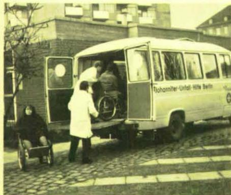
Mit einer hydraulischen Hebebühne, die hinten am Fahrzeug unter der Doppeltür angebracht worden ist, können die Gehbehinderten mühelos und vor allem sicher ein- und aussteigen, ohne den Rollstuhl verlassen zu müssen. Eine besondere Verankerung ermöglicht es, daß die Gehbehinderten auch während der Fahrt in ihrem Rollstuhl sitzen bleiben können.
