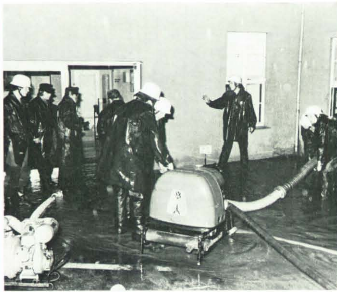
Die Feuerwehr beim Lenzen vollgelaufener Keller.
