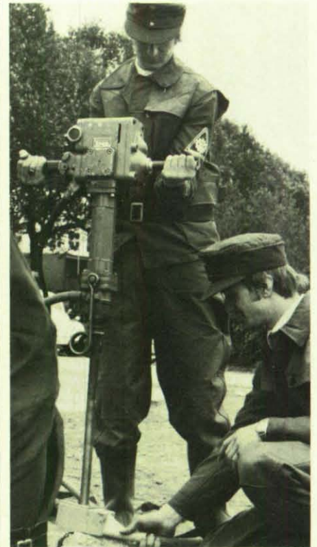
Demonstration des Gebrauchs eines Gesteinsbohrhammers. Für das Publikum wurden diese und ähnliche Tätigkeiten über Lautsprecher erläutert.
