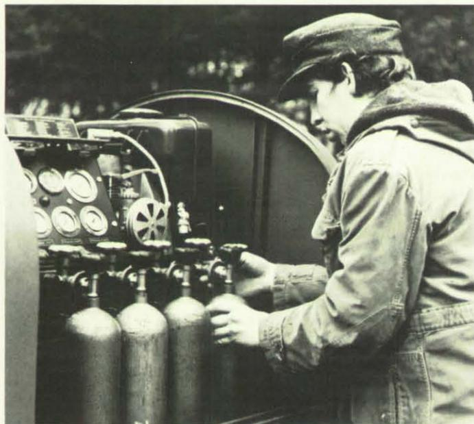
Mit einem Atemluftkompressor werden die Preßluftflaschen gefüllt. Um einen größtmöglichen Reinheitsgrad der Druckluft zu erhalten, wird die angesaugte und komprimierte Luft gründlich gefiltert.
