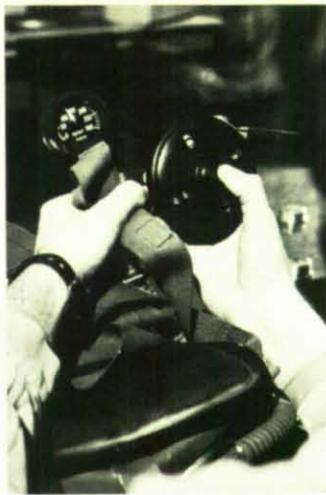
**Vor dem Gebrauch müssen alle Einzelteile auf ihre Einsatzbereitschaft geprüft werden. Mit Hilfe des Lungenautomaten (rechts) und des Druckmessers läßt sich der Preßluftdruck jeder Flasche prüfen.**
