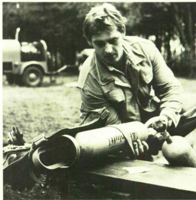
**Die Einsatzdauer des Preßluftatmers richtet sich nach dem Luftvorrat und nach der Arbeitsleistung des Trägers. Das Gerät hat zwei Flaschen zu je vier Litern Inhalt. Bei einem Fülldruck von 200 kg/cm<sup>2</sup> sind das 1600 Liter.**
