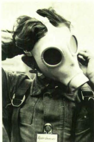
**Im Katastrophenschutz wird zum Preßluftatmer die ABC-Schutzmaske Z 56 getragen. Der Filtereinsatz FE 55 wird vorher entfernt. An seine Stelle tritt der Lungenautomat.**
