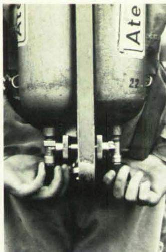
**Zur Überprüfung der Einsatzbereitschaft gehört eine Reihe von bestimmten Handgriffen in vorgeschriebener Folge. Die beiden Flaschenventile, die der Geräteträger hier betätigt, sind leicht zugänglich.**
