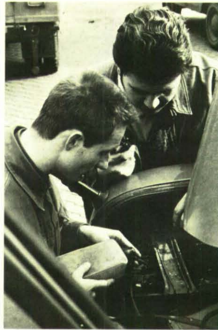
Bei der regelmäßigen Batteriekontrolle wird destilliertes Wasser nachgefüllt.
