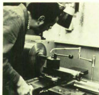
Zur Ausstattung der KatS-Zentralwerkstatt gehört auch diese Drehbank, auf der schon viele handelsüblich nicht mehr zu erhaltende Ersatzteile und Sonderwerkzeuge hergestellt worden sind.
