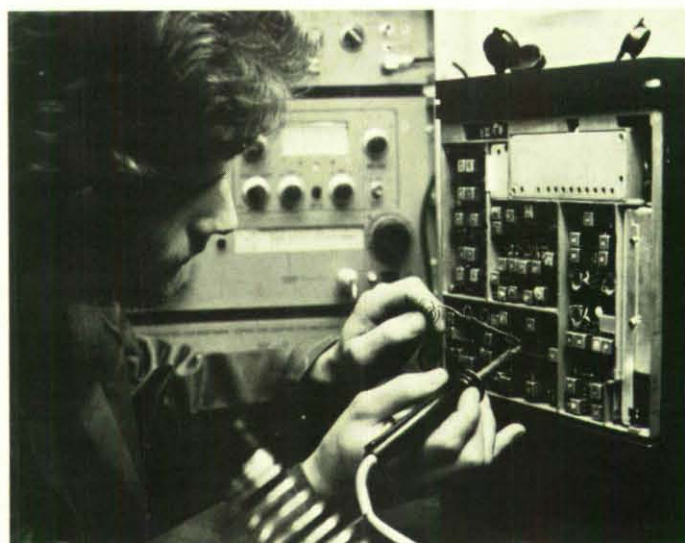
Prüfung und Instandsetzung vor allem der diffizilen Sprechfunkgeräte erfordert den Einsatz von qualifizierten Fachkräften. Da die Fernmeldegeräte zusammen mit den Fahrzeugen in die KatS-Zentralwerkstatt gebracht und dort gleichzeitig in den zuständigen Fachwerkstätten „behandelt“ werden, bedeutet das eine wesentliche Vereinfachung und Rationalisierung der Materialerhaltung.
