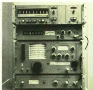
Die genaue Überprüfung der Fernmelde-Geräte verlangt hochwertige Spezial-Meßgeräte, wie Frequenzzähler, Frequenz-Controller, Meßsender und Signal-Generator sowie Leistungsmeß-Adapter.
