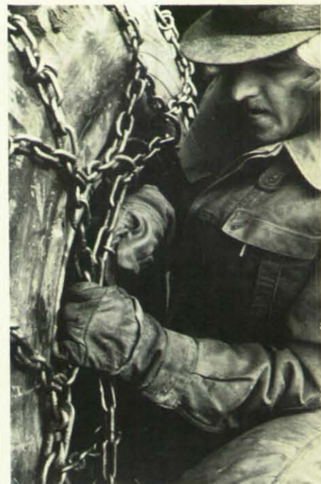
Mit Gleitschutzketten versehene schwere LKW können Schneehöhen bis zu 40 cm passieren.
