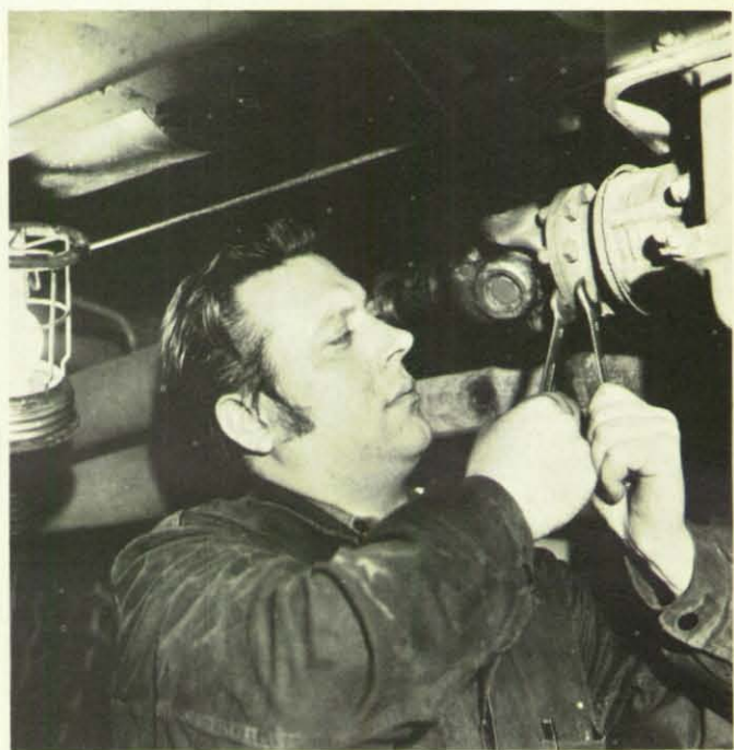
Ein Kfz-Handwerker beim Nachziehen der Gelenkwellenschrauben. In der Zentralwerkstatt in Hohenbrunn werden pro Woche regelmäßig sechs bis acht Kraftfahrzeuge durchgeschleust. Alle Mängel und Schäden werden sofort behoben.
