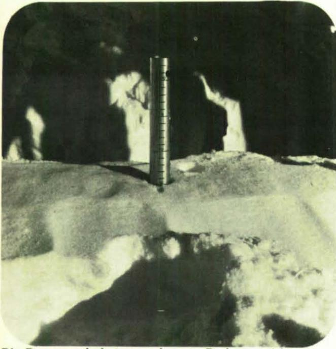
Die Rammsonde hat gewachsenen Boden erreicht. Zahl der Schläge, Fallhöhe des Rammhärens und Einsinktiefe werden zur Ermittlung des Rammprofils in ein Formblatt eingetragen.
