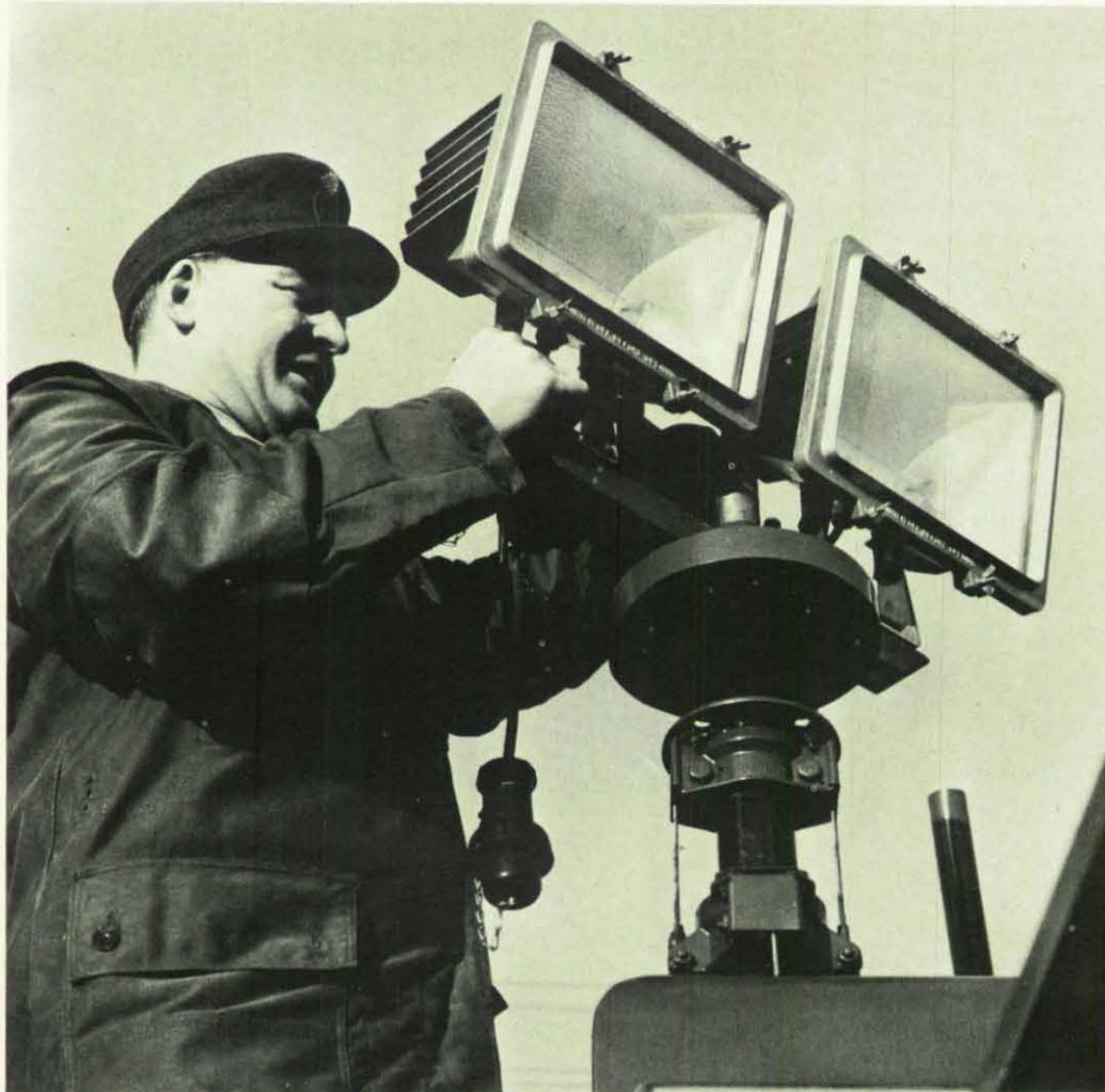
Die Montage der Flutlichtanlage ist relativ einfach. Die vier Halogen-Scheinwerfer mit je 1000 Watt lassen sich mit wenigen Handgriffen paarweise zerlegen.
