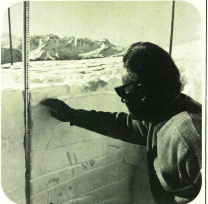
Die Schneewand wird entlang der Rammsonde geglättet und die Schichtgrenzen, die oft nur fühlbar und mit dem Auge nicht mehr erkennbar sind, werden mit der Handkante markiert.
