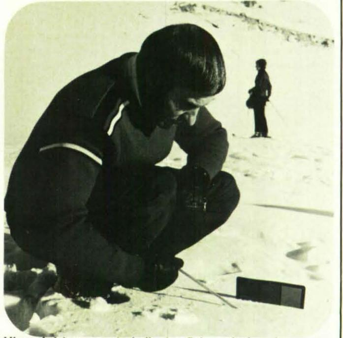
Hier wird knapp unterhalb der Schneedeckenobergrenze die Schneetemperatur gemessen. Daneben sieht man ein Schneeraster zur Bestimmung der Kornart und Korngröße der Schneekristalle.
