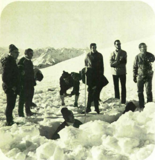
Der Rammwiderstand ist gemessen, das Rammprofil erstellt; jetzt wird die Schneedecke — auf unserem Bild von Lehrgangsteilnehmern — zum Zwecke der Aufnahme eines Schichtprofils aufgegraben.
