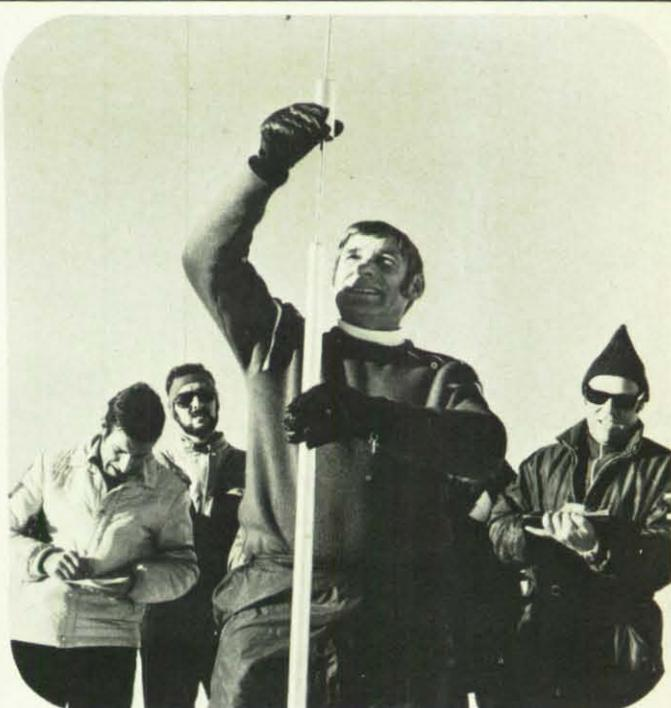
Hier wird mit der Messung des Rammwiderstandes einer Schneedecke begonnen. Die Rammsonde wird mit dem Rammhären immer tiefer in den Schnee gerammt, bis die Sonde den Boden erreicht.
