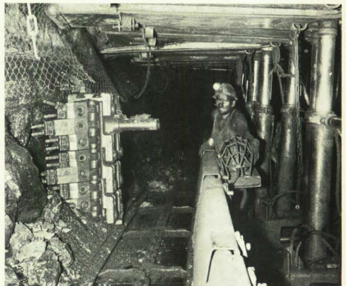
Im tiefsten Abbaubetrieb des Ruhrgebietes (1 308 Meter) auf der Zeche „Ewald III/IV“ in Herten. Mannshoch ist der Hobel, der die Kohle vom Stoß löst. Seitlich sichtbar der moderne Stahlausbau.
