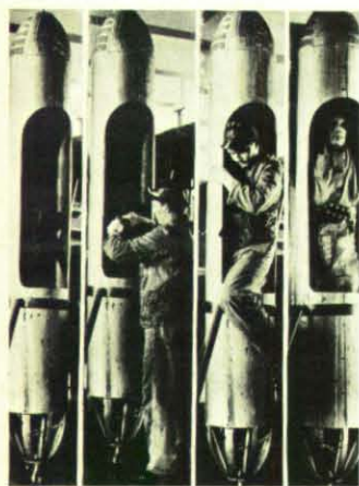
Eine Fotomontage von der 1963 in Lengede verwendeten Rettungsbombe, die — eingesetzt von der Hauptstelle für das Grubenrettungswesen in Essen-Kray — sich bereits mehrfach bei der Bergung Verschütteter bewährte.
