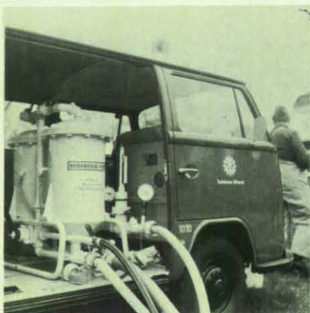
Kombi mit eingebauter Filteranlage
