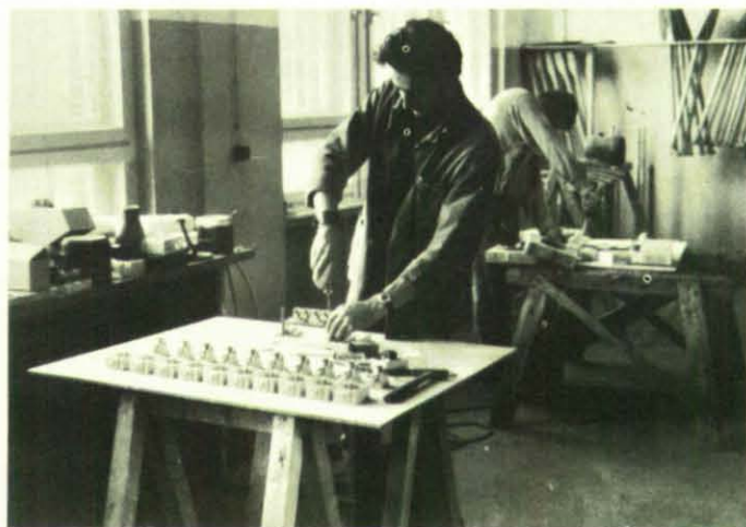
Verteilertafeln mit zehn Außensteckdosen wurden von THW-Helfern angefertigt.
