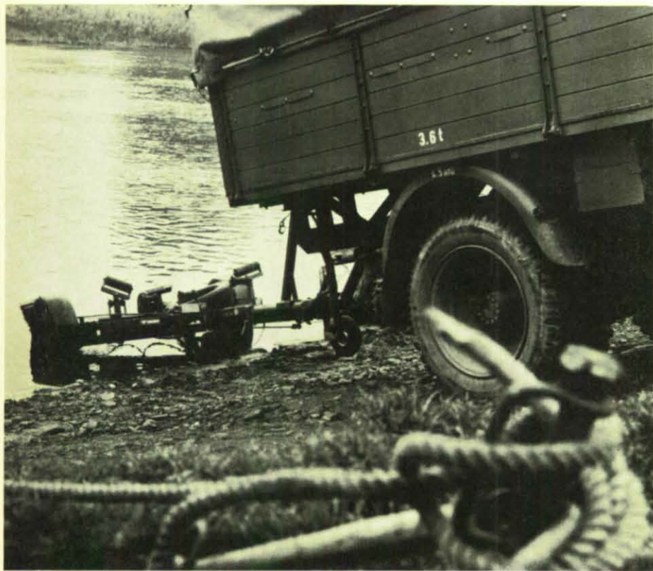
Der Anhänger wurde für den Schnelleinsatz von Mehrzweckbooten konstruiert. Er paßt an alle Anhängerkupplungen von Fahrzeugen des Katastrophenschutzes. Die Kupplungen können ausgewechselt und mit Hilfe eines Verstellstückes eingestellt werden.
