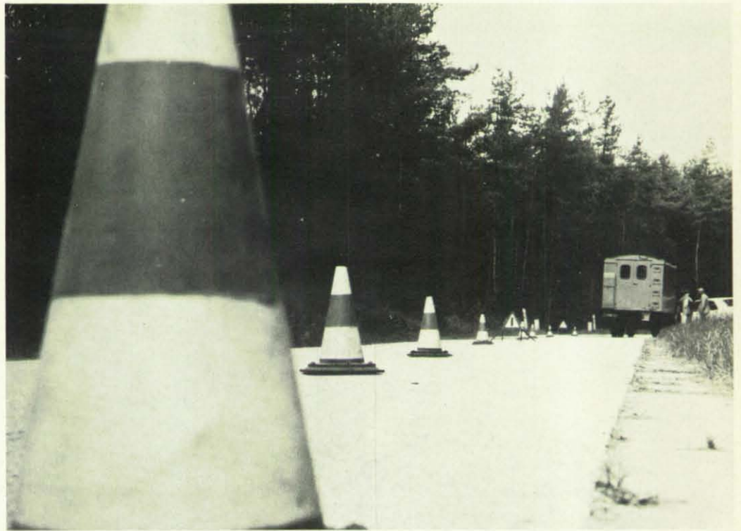
Nach den Erfahrungen der Polizei bei der Absicherung stehender Fahrzeuge oder Einsatzeinheiten ist eine langgezogene, gestaffelt aufgestellte Verkehrsicherung besonders auffällig. Jedes KatS-Fahrzeug sollte darum acht bis zehn dieser Leitkegel mit sich führen.
