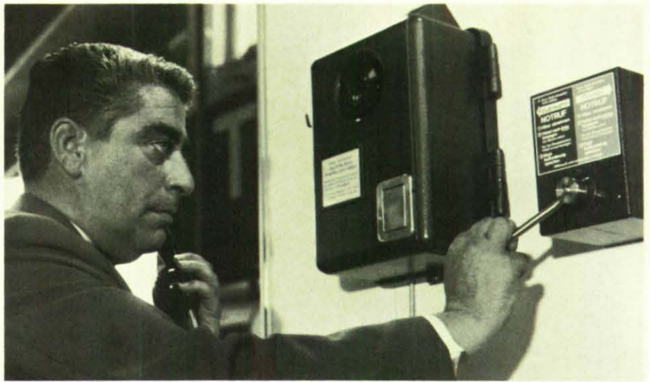
In diesem Münzfernsprecher ist ein Notrufmelder eingebaut — ein Hebeldruck nach links stellt die Verbindung zur Feuerwehr und ein Hebeldruck nach rechts die Verbindung zur Polizei her.
