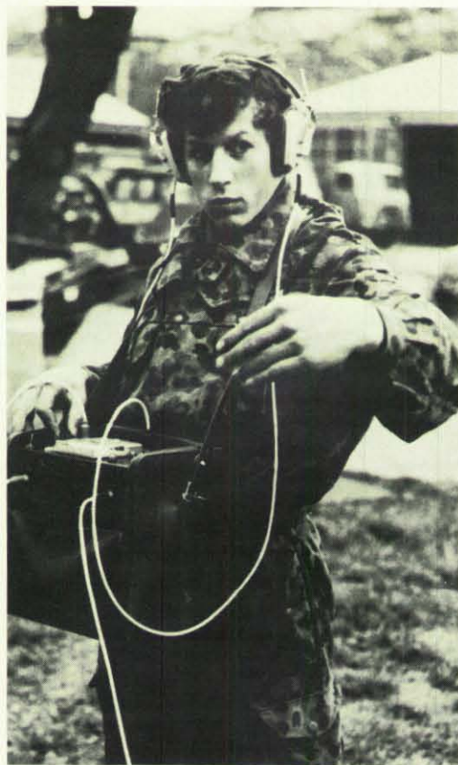
Das Birophongerät reagiert mit Ton- signalen auf unterirdische Geräusche wie Schreien, Stöhnen, Klopfen, Scharren.
