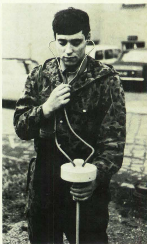
Das Capsongerät: Eine Eisenstange ist mit einem Resonator verbunden, an den ein Stethoskop angeschlossen wird.
